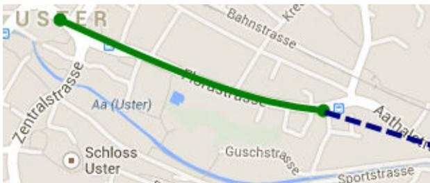
Ab Aathalstrasse soll im Tunnelbau-Verfahren ein neues doppelspuriges Gleis bis kurz vor der Station Aathal im Bereich Sauriermuseum gebohrt werden. Hier werden Abklärungen über mögliche Auswirkungen wegen des Grundwassers im Bereich des Aabachs nötig sein.
